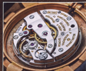
ジャガール・ルクルトの手巻キム・ワグナンと名匠によって作られたスモールセコンドタイプのCal.45B/3Bを搭載する。17石で毎時178000振動
